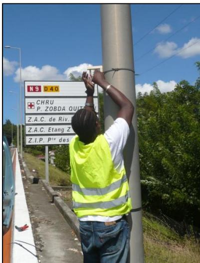
Les tubes sont posés à environ 2 mètres du sol, essentiellement pour des raisons de vandalisme, sur des supports (lampadaire, poteau...) et restant représentative de l'air respirable. Les tubes sont posés sur des supports en bois qui sont fixés au poteau à l'aide de collier de serrage.
