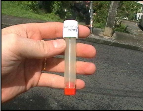
La méthode de prélèvement du  $\text{NO}_2$  est celle des tubes passifs. Le principe général consiste en un tube vertical ouvert à sa partie inférieure, et contenant en sa partie supérieure interne, un support solide (grilles) imprégné d'une substance chimique (triéthanolamine+BRIJ35) adaptée à l'absorption de  $\text{NO}_2$  qui diffuse naturellement dans le tube.
