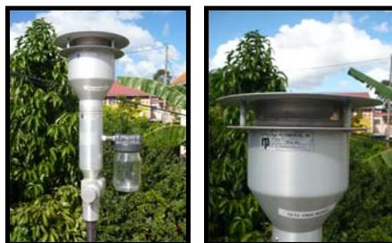
La tête de prélèvement  $\text{PM}_{10}$  permet un échantillonnage représentatif des fractions de poussières pouvant pénétrer dans le système respiratoire des bronches supérieures. Elle sépare
