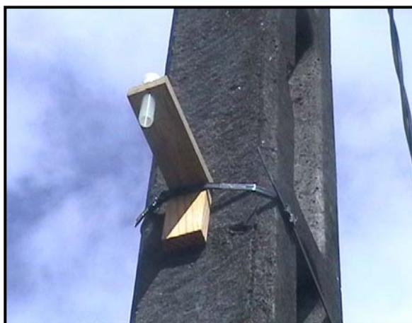
Ces tubes sont préparés selon une méthode spécifique. Des petites grilles d'acier imprégnées d'un réactif chimique fixant le dioxyde d'azote : le triéthanolamine (TEA) sont placées au fond des tubes. La grille est ensuite fixée à l'extrémité du tube à l'aide d'un bouchon plastique étanche. Le même type de bouchon sera utilisé pour fermer l'autre extrémité et sera retiré au moment du prélèvement.
