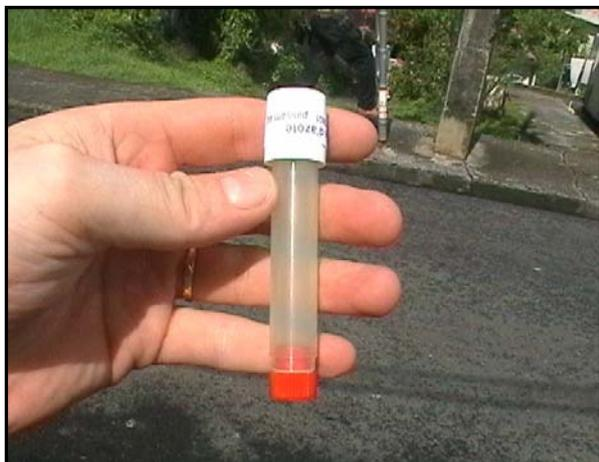
La méthode de prélèvement du  $\text{NO}_2$  est celle des tubes passifs. Cette méthode a été proposée par Palmes et coll. en 1976 et est utilisée depuis vingt ans pour des campagnes de mesure de ce type après avoir été mise au point par le centre technique d'ISPRA (Italie), un organisme travaillant sur les normes européennes de mesure.
