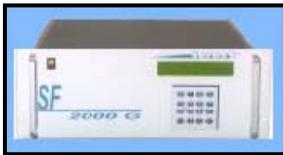
Le prélèvement s'effectue par une tête de prélèvement qui récupère l'air extérieur. Celui-ci arrive ensuite dans un analyseur de Fluorescence U.V. permettant l'analyse du SO<sub>2</sub> en temps réel.
