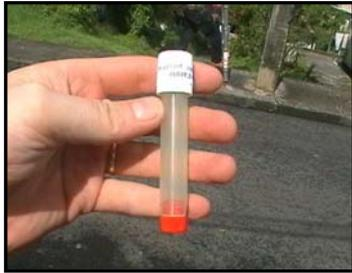
Le tube sera laissé ouvert pendant une période de 15 jours, puis remplacé par un autre. On notera toutes les indications pouvant être utiles (fissures du tube, présence de toiles d'araignées dans le tube, vol du tube ...).
