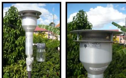
La tête de prélèvement PM<sub>10</sub> permet un échantillonnage représentatif des fractions de poussières pouvant pénétrer dans le système respiratoire des bronches supérieures. Elle sépare les poussières selon leur granulométrie et ne sélectionne que les particules de diamètre inférieures à 10µm (PM<sub>10</sub>).
