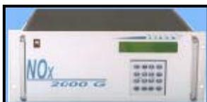
L'analyse est réalisée à l'aide d'un appareil de mesure en continu, par chimioluminescence. Il nous fournit ainsi une concentration en temps réel en dioxyde d'azote (NO<sub>2</sub>), monoxyde d'azote (NO) et en oxyde d'azote (NO<sub>x</sub>).
