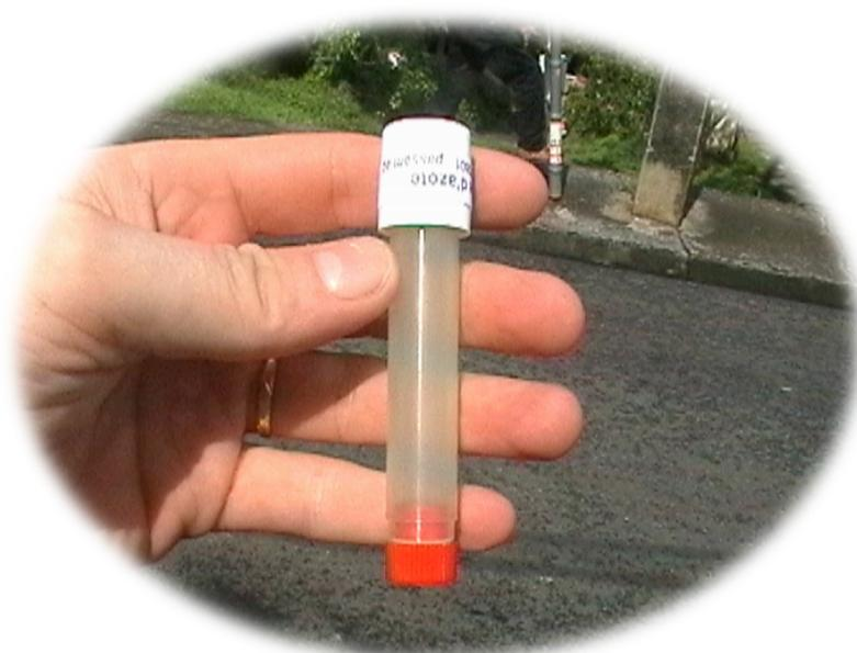
Photo III-2 : Tube passif pour le  $\text{NO}_2$
