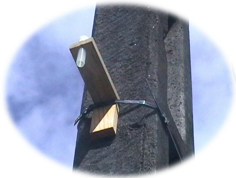
Photo III-3 : Tube passif pour le NO<sub>2</sub>, posé sur son site
