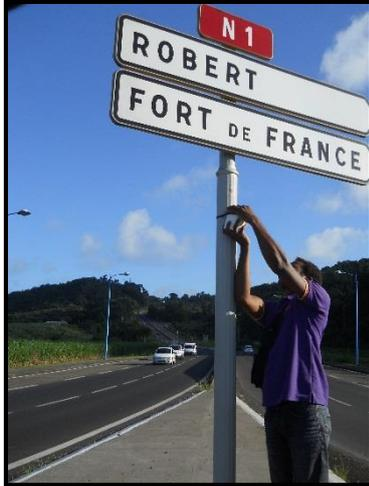
La méthode de prélèvement du NO<sub>2</sub> est celle des tubes passifs. Le principe général consiste en un tube vertical ouvert à sa partie inférieure, et contenant en sa partie supérieure interne, un support solide (grilles) imprégné d'une substance chimique (triéthanolamine+BRIJ35) adaptée à l'absorption de NO<sub>2</sub> qui diffuse naturellement dans le tube.
