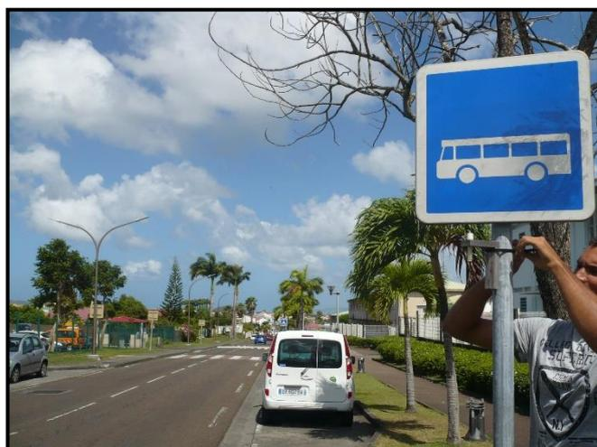
Les tubes sont posés à environ 2 mètres du sol, essentiellement pour des raisons de vandalisme, sur des supports (lampadaire, poteau...) et restant représentative de l'air respirable. Les tubes sont posés sur des supports en bois qui sont fixés au poteau à l'aide de collier de serrage.
