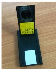
KODALPHA est un dosimètre passif de type ouvert pour la mesure intégrée de l'activité volumique du radon dans l'environnement atmosphérique, conformément à la norme NF ISO 11665-4. Le dosimètre est équipé d'un Détecteur Solide de Traces Nucléaires DSTN, « film » en nitrate de cellulose de type LR115, qui enregistre les particules alpha émises par le radon - et ses descendants à vie courte - présents dans l'environnement du détecteur.
