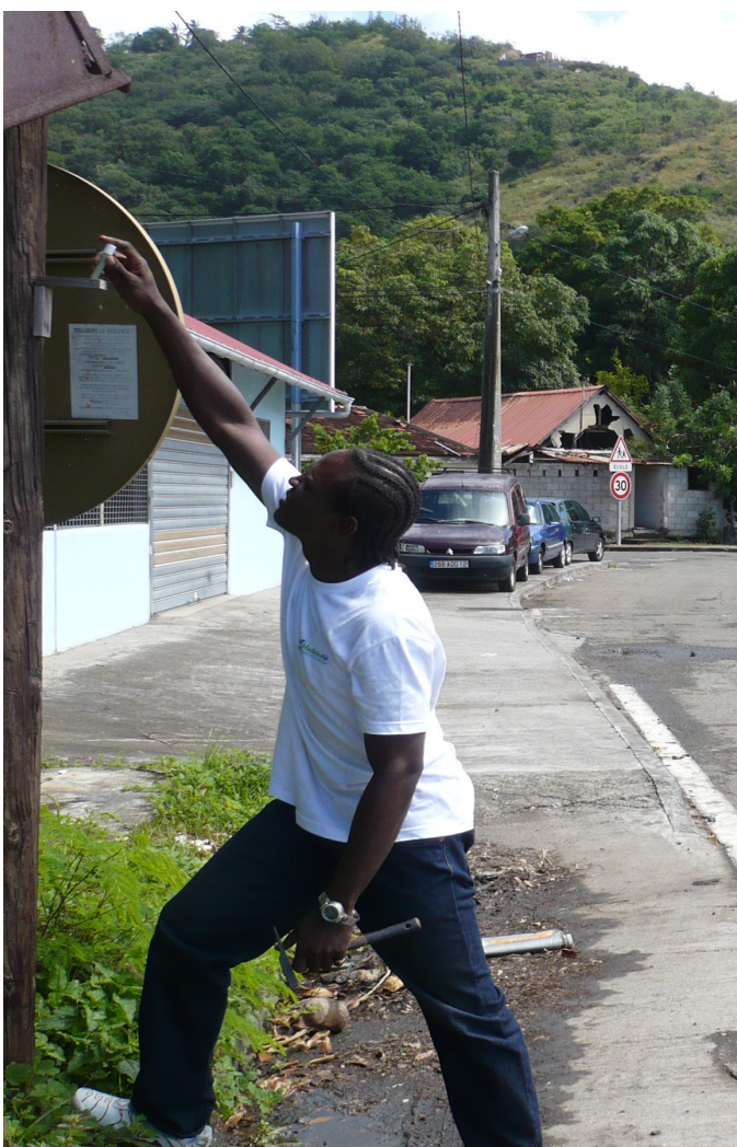
Pose de tubes passifs NO 2 à Bellefontaine
