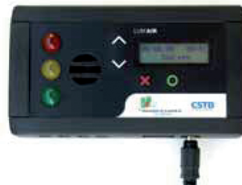
Lum'Air, appareil de mesure du confinement
