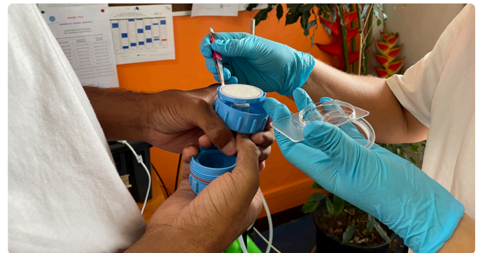
Prélèvement de particules sur filtre dans le cadre du projet SAMBA
