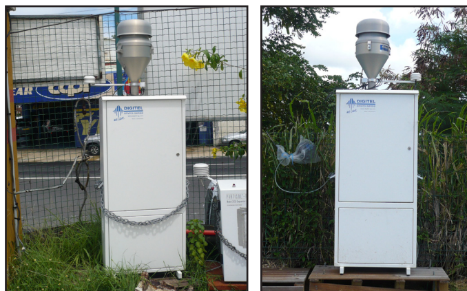
Préleveur des Hydrocarbures Aromatiques Polycycliques sur les sites de Bishop (à droite) et Fort Saint-Louis (à gauche)
