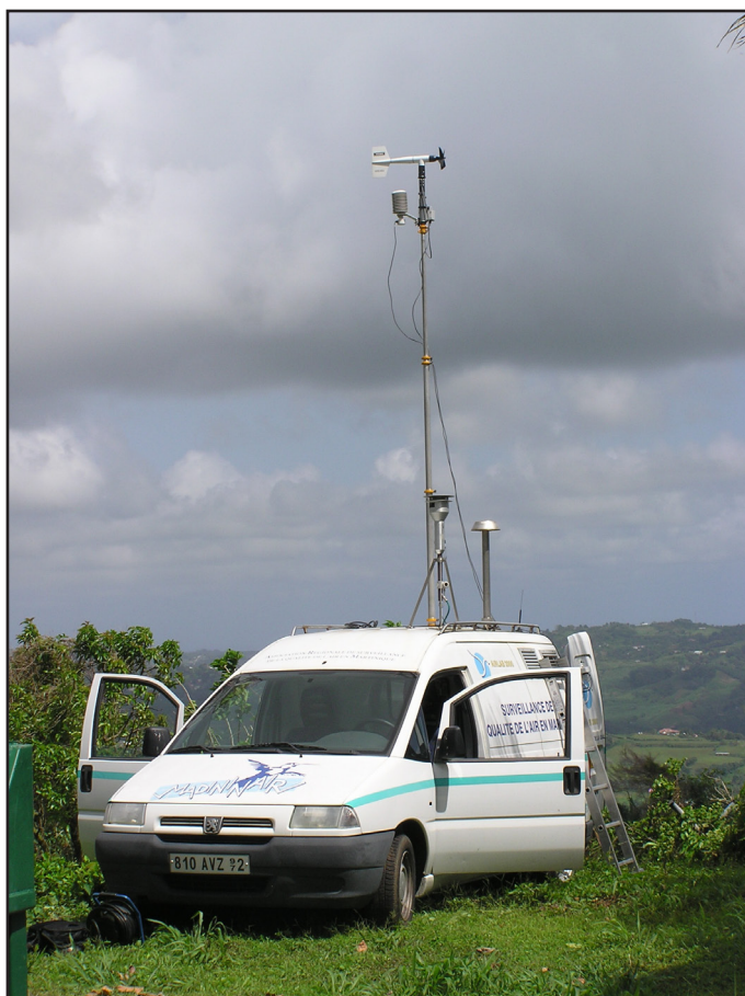
Moyens de surveillance de la qualité de l'air : camion laboratoire (ci-dessus) et station de mesure fixe au Lamentin (ci-contre)
