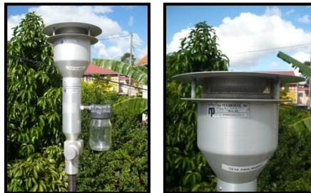
La tête de prélèvement PM10 permet un échantillonnage représentatif des fractions de poussières pouvant pénétrer dans le système respiratoire des bronches supérieures. Elle sépare les poussières selon leur granulométrie et ne sélectionne que les particules de diamètre inférieures à 10µm (PM10).
